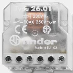
**Descrizione tecnica:** Stromstoßrelais, Da incasso terminali a vite, Interruttore unipolare 1 NO, 10 A, Bobina AC, 230 V, funzionamento da 184 a 253 V, potenza nominale 4.5 VA, resistenza 6250  $\Omega$ , assorbimento 20 mA, temperatura ambiente da -40 a +40 °C
