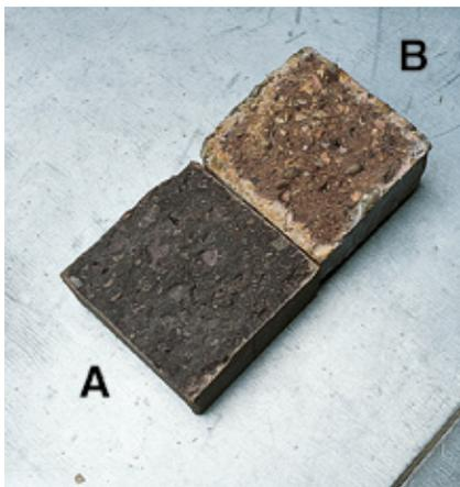
**Fig. 2 B - Prove di penetrazione dello ione cloruro (UNI 9944).** Il campione A, rivestito con Mapelastic, risulta non penetrato; il campione B, tal quale, presenta un fronte di avanzamento di diversi millimetri
