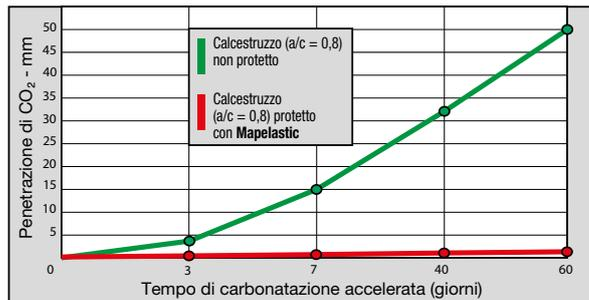
**Fig. 2: Effetto di Mapelastic sulla carbonatazione accelerata (30% di CO<sub>2</sub>) in un calcestruzzo poroso**
