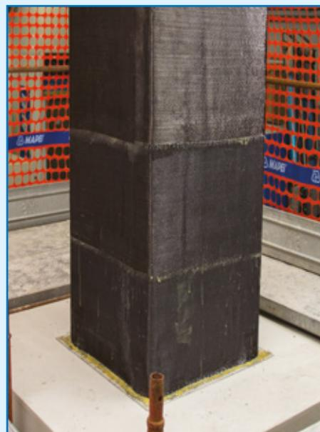
Pilastro confinato con MapeWrap C UNI-AX System
