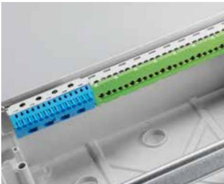
Per velocizzare e rendere più ordinato il cablaggio, sono installabili a scatto vari tipi di morsettiere (opzionali e in due differenti colori), sia nella parte superiore del centralino che in quella inferiore. I morsetti sono in due versioni: con viti e ad innesto rapido, per facilitare e rendere efficace il cablaggio con qualsiasi tipo di conduttore.
