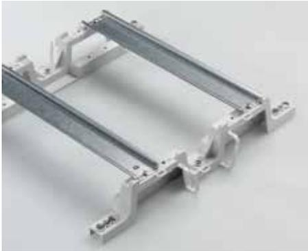
Il telaio, completamente estraibile, rende più agevole e rapido il cablaggio realizzato a banco. I fori asolati ricavati nel telaio ne permettono il successivo e rapido fissaggio all'interno del contenitore.
