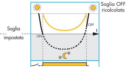
L'innovativo principio di compensazione dell'influenza delle lampade comandate evita fastidiosi spegnimenti e accensioni causati da un'errata installazione.
