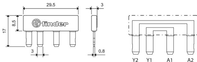
Per la connessione diretta dell'uscita ausiliaria del 11.91 (Y1-Y2) ai terminali di alimentazione del 19.91 (A1-A2)
