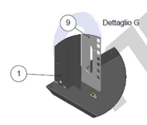
Struttura portante (1) in lamiera di acciaio, totalmente smontabile composta da 4 piantane angolari con forature per il fissaggio degli accessori
