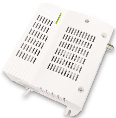
Alimentatore **12V 1,4A con connettore F maschio** senza inseritore DC; ideale per alimentare il multiswitch **SCD2-4..16LTP** quando i decoder non riescono a sostenere il carico sulla derivata.
