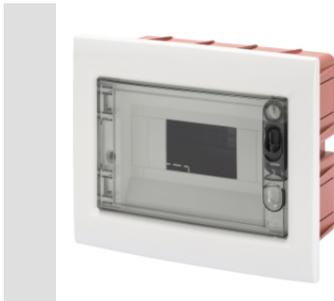
Gamma di centralini da incasso protetti IP40, disponibili nelle taglie da 2 a 72M, con porta trasparente fumè particolarmente indicati per i settori terziario ed industriale e con porta cieca, ideali per dispositivi domestici. Accessoriabili con morsettiere bipolari e unipolari da 80 A e 125 A, con cablaggio a vite, che consentono di realizzare un cablaggio semplice ed ordinato riducendo i tempi per la messa in opera del centralino.
