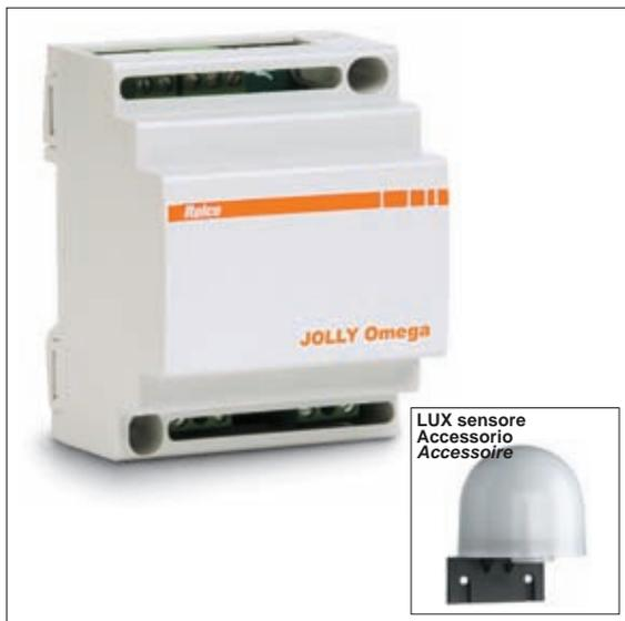
Interfaccia con comando a pulsante esterno (non fornito), per lampade fluorescenti equipaggiate di reattori elettronici con segnale di comando 1÷10V, ingombro 4 moduli DIN.
